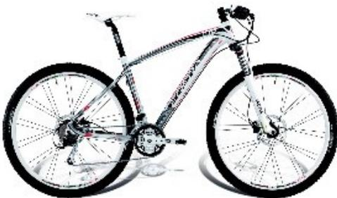
Prévu pour rouler sur des terrains très accidentés, sur la terre, les cailloux ou dans la boue, il est équipé d'un cadre renforcé traité anti-corrosion, de pneus larges aux dessins profonds et d'un grand nombre de vitesses.
